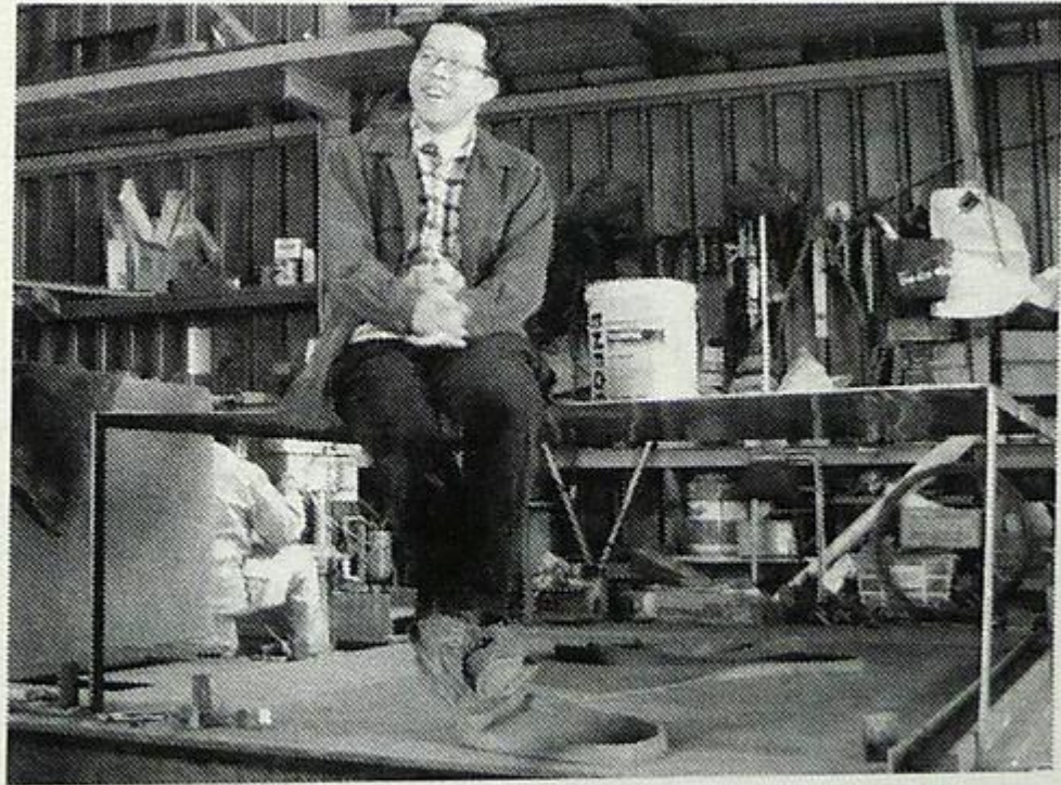
図 4 テーブルに座りたわみを確認する筆者 (図 1・2・4 ©石上純也建築設計事務所)
